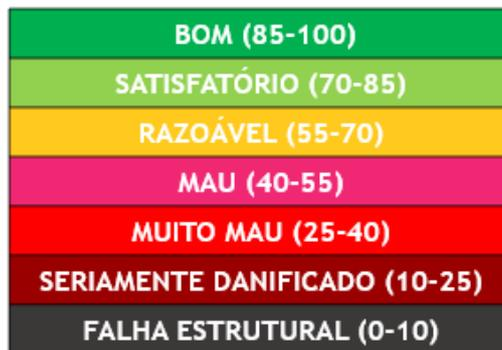
Figura 2.6 - Escala de classificação do PCI (adaptado de AC 150/5380-7B, 2014).
