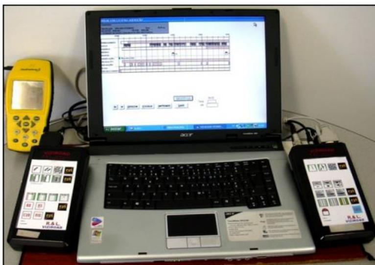
Figura 3.4 - Equipamento VIZIROAD com GPS associado (Horta, et al., 2013).
