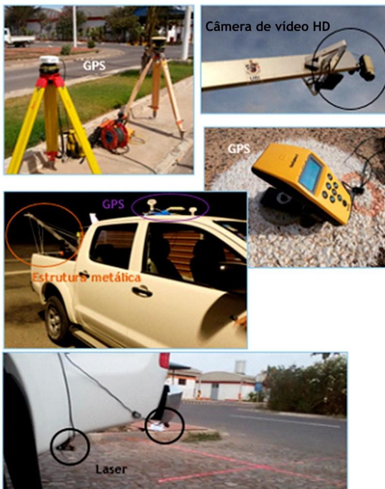
Figura 5.1 - Equipamentos usados no sistema móvel multifuncional de baixo custo desenvolvido no DECA-UBI (Lima, 2016).
