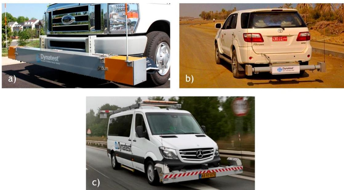
Figura 3.5 - a) Perfilômetro Laser RPS-III; b) Perfilômetro Laser RPS-IV; c) Veículo Multifuncional (MFV) (adaptado de Dynatest International, 2017).
