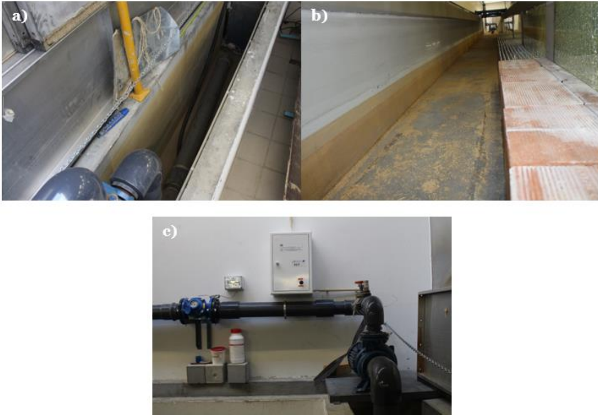
Figura 3.3: Canal hidráulico: a) Reservatório; b) Canal; c) Bomba e medidor de caudal eletromagnético
