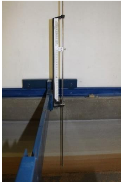
Figura 3.8: Hidrómetro instalado no carrinho do canal
