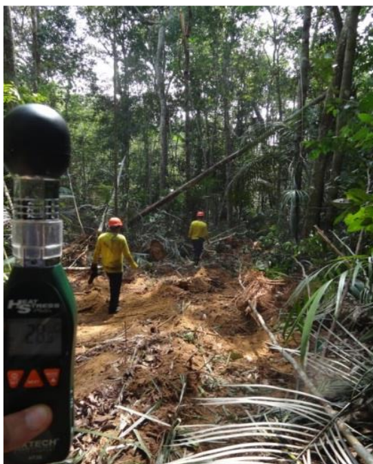
Figura 03. Equipamento portátil para medição de índice IBUTG modelo HT30 Extech, durante coleta de dados.
