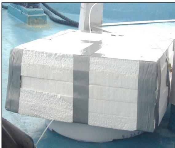
**Figura 6:** Câmara flutuante de coleta de GEE.
