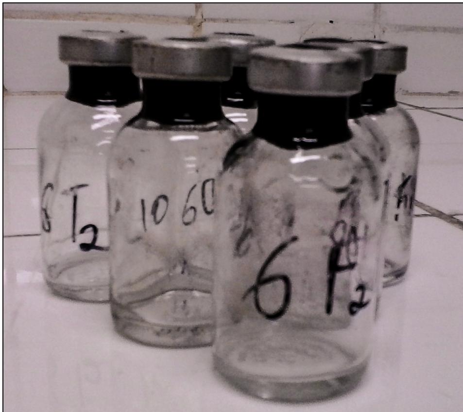
**Figura 8:** Frascos utilizados para coleta dos gases de feito estufa.
