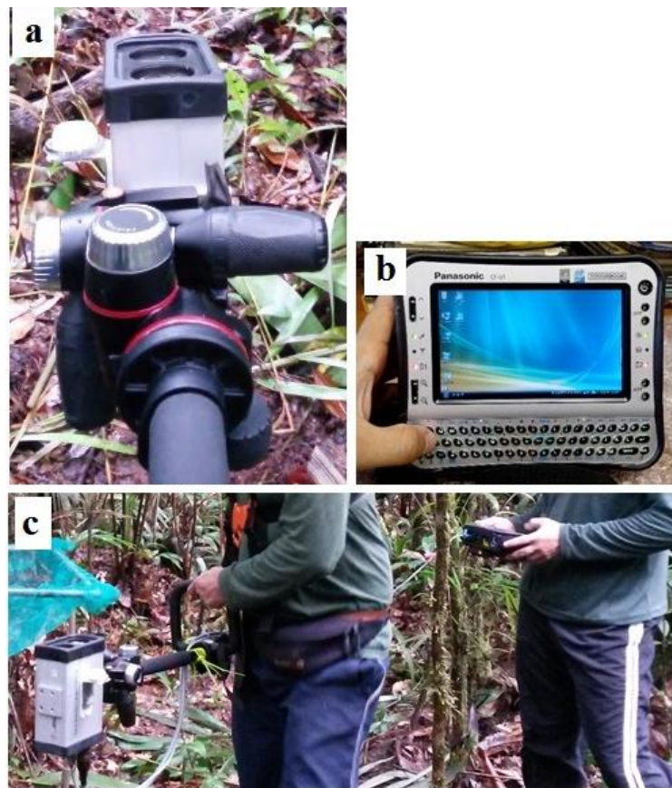
Figura 5. Sistema LiDAR portátil terrestre: sensor LiDAR (a), computador ( Toughbook ) (b) sistema completo e operadores (c).
