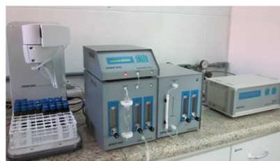
Figura 4. Laboratório de campo montado a bordo da embarcação utilizada durante as coletas; e laboratório de análises contendo o destilador de amostras de água e o aparelho MERX utilizados. Fotos: Daniele Kasper.
