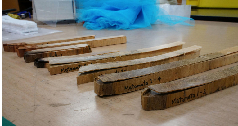
Figure 16: Raio selecionado com a lâmina de 1 mm na parte superior. A lâmina é utilizada para extração da celulose.
