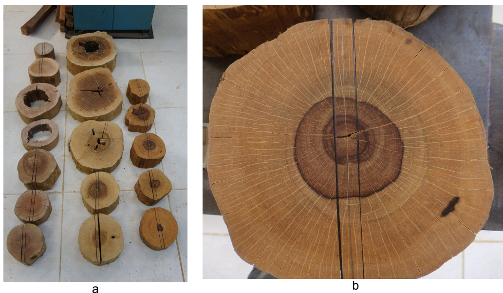
Figura 15: Discos coletados para análise isotópica: a. Discos do DAP de três morfoespécies; b. Disco de Ucuuba com os raios marcados para fazer o corte.
