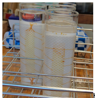
Figura 20: Amostras de madeira durante o processo de extração de celulose: a - Amostras sendo preparadas para passar pelo processo de extração da lignina; b - Amostras da celulose das lâminas de madeira.
