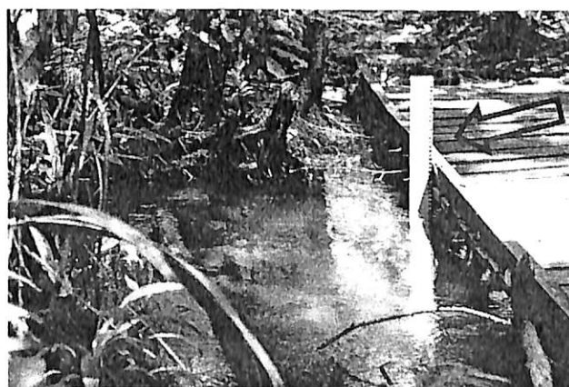
Figura 10: Régua de profundidade instalada no ponto da descarga do igarapé. (Foto: Projeto LBA, 2004)
