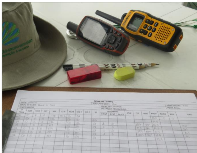
Figura 6: Planilha de campo para anotação dos dados coletados durante a avistagem, aparelho GPS para posição geográfica e rádio portátil para comunicação entre as plataformas (proa e popa).
