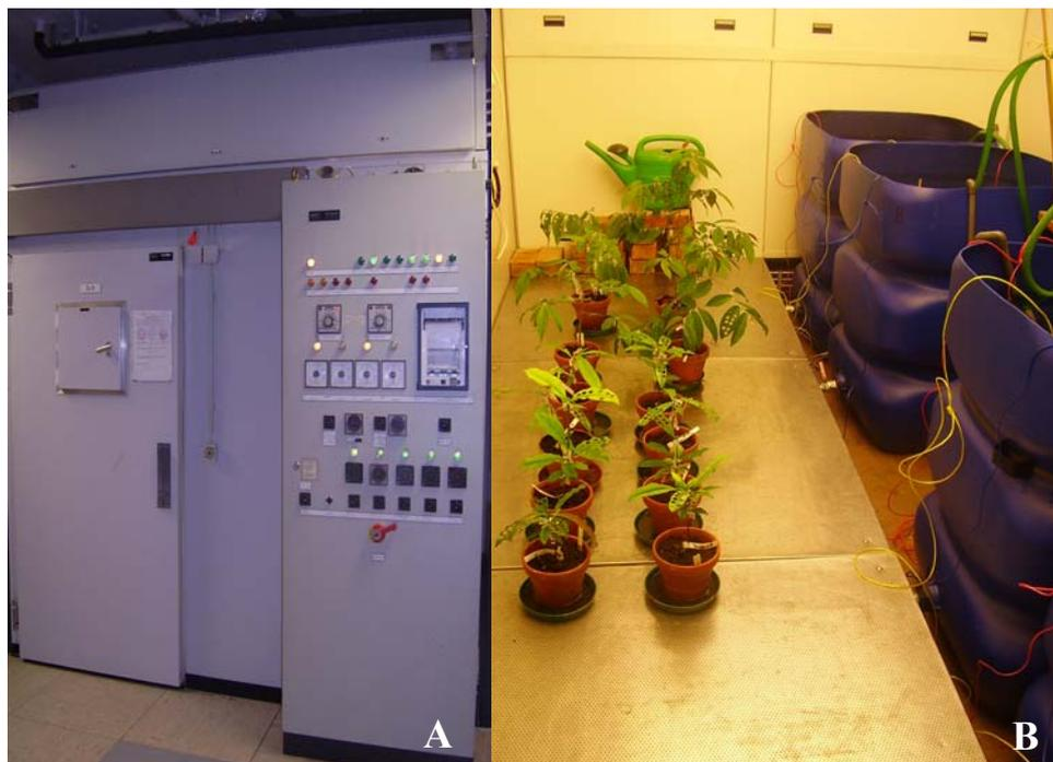
Figura 2. Vista externa da Câmara Climática, mostrando painel de controle das condições ambientais à direita (A), e vista interna com as plântulas e os tanques para o experimento de inundação artificial (B).
