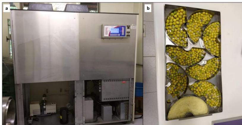
Figura 14. Câmara de liofilização (a); Frutos pós-liofilização com aparência original preservada (b);
