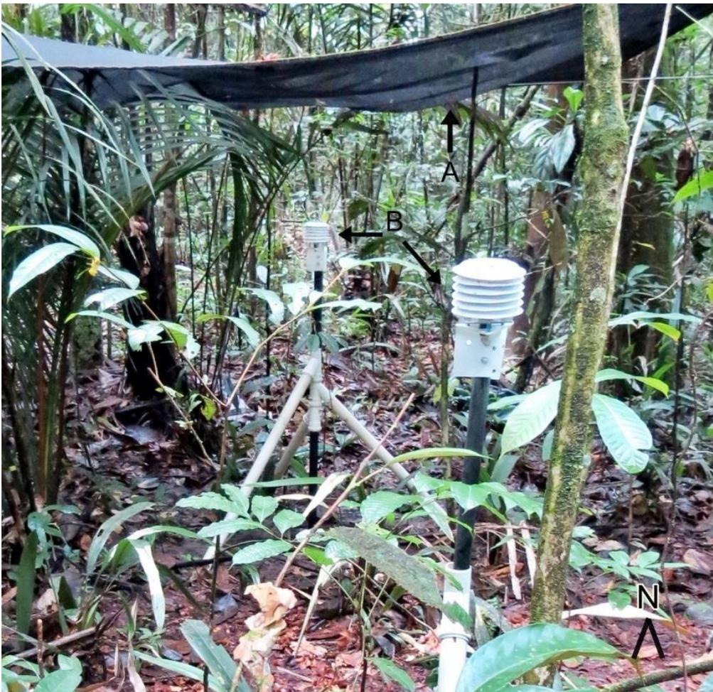
**Anexo 1.** Parcela montada em campo. A imagem mostra a área sombreada ao norte da área controle. Tela de sombreamento (A) utilizada para bloquear parcialmente (80%) a luminosidade. Torres de coleta (B) utilizadas para o suporte dos sensores de dados climáticos locais.
