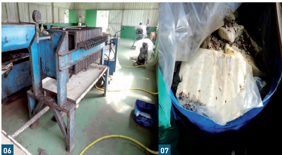
Figuras 06 e 07 - Na figura 06, uma das máquinas utilizadas no processo de extração do óleo da andiroba e da manteiga de murumuru. O maquinário fica sob responsabilidade da CODAEMJ. Na figura 07, a manteiga de murumuru extraída. Os meios de produção podem ser considerados como arcaicos, mas no momento atendem as necessidades dos moradores. FONTE: Marciclei Bernardo/ Outubro - 2013.
