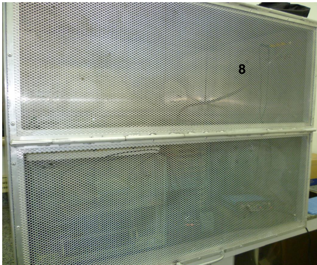
Figuras 5 e 6: (1) Termocirculador; (2) caixa de Faraday aberta; (3) aquário banho-maria; (4) aquário experimental com 5L de água, que será colocado dentro do aquário banho-maria; (5) abrigo vazado; (6) três eletrodos de ouro; (7) bioamplificador diferencial AC/DC ® ; (8) caixa de Faraday fechada durante os experimentos para as gravações das DOEs.
