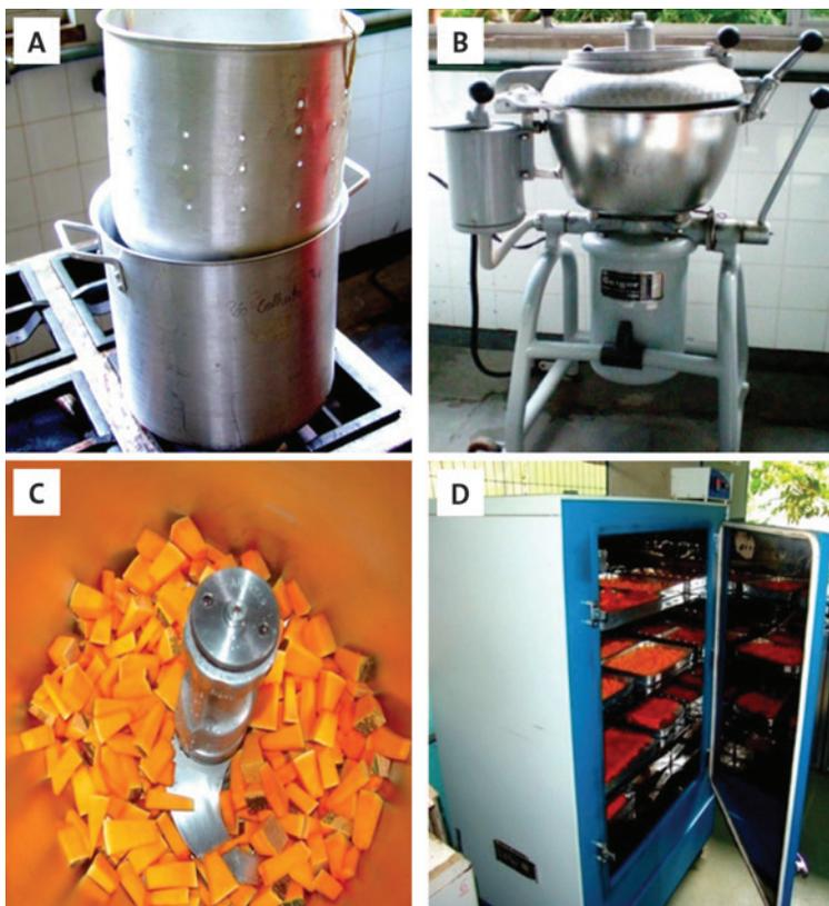
**Figura 2.** Sistema de panelas (sobrepostas, sendo a interna perfurada formando um cesto) utilizado para o tratamento térmico (a); visão externa (b) e interna (c) do multiprocessador empregado para a trituração das abóboras (*Curcubita* spp.) antes e após a desidratação; estufa com circulação forçada de ar (d) usada para a desidratação.
