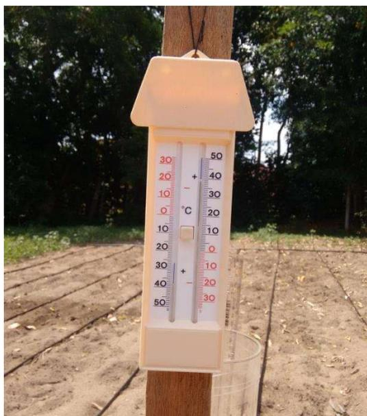
**Figura 10.** Termômetro de máxima e mínima.
