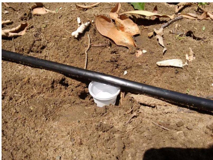
**Figura 8.** Teste de vazão sendo executado.
