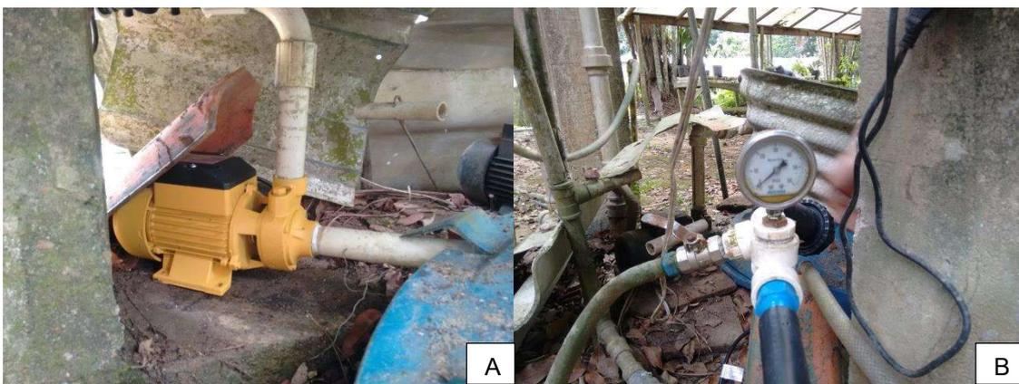
**Figura 6.** Bomba d'água (A) e manômetro (B) utilizados no experimento.
