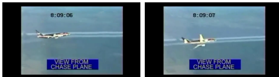
(α') Το Boeing 737 μπαίνει στην περιοχή των αναταράξεων (β') Περίπου ένα δευτερόλεπτο μετά, έχει αποκτήσει μεγάλη κλίση
