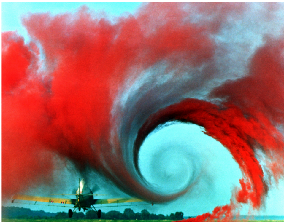
Σχήμα 3.1: Φωτογραφία από μελέτη της NASA για τις αναταράξεις, όπου φαίνεται το σχήμα των αναταράξεων που δημιουργεί η πτέρυγα αυτού του μικρού αεροσκάφους. Πηγή: http://lisar.larc.nasa.gov/UTILS/info.cgi?id=EL-1996-00130
