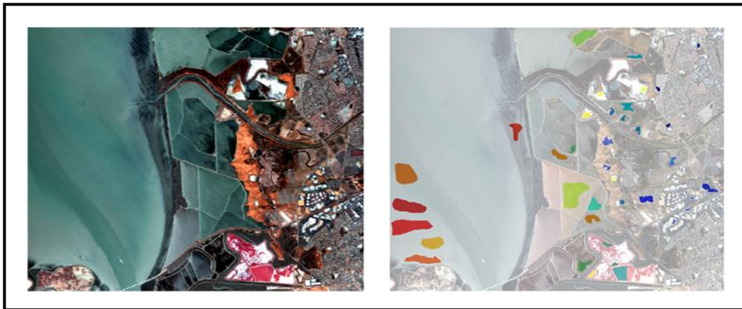
Εικόνα 4.27: Έγχρωμο σύνθετο της εικόνας 2008-1, με τα αντίστοιχα δεδομένα Ground Truth
