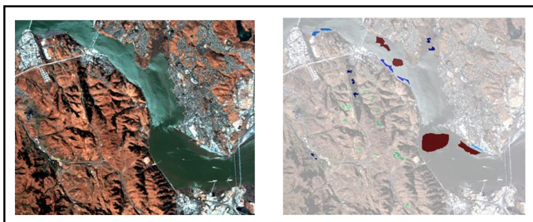
Εικόνα 4.31: Έγχρωμο σύνθετο της εικόνας 2014-1, με τα αντίστοιχα δεδομένα Ground Truth
