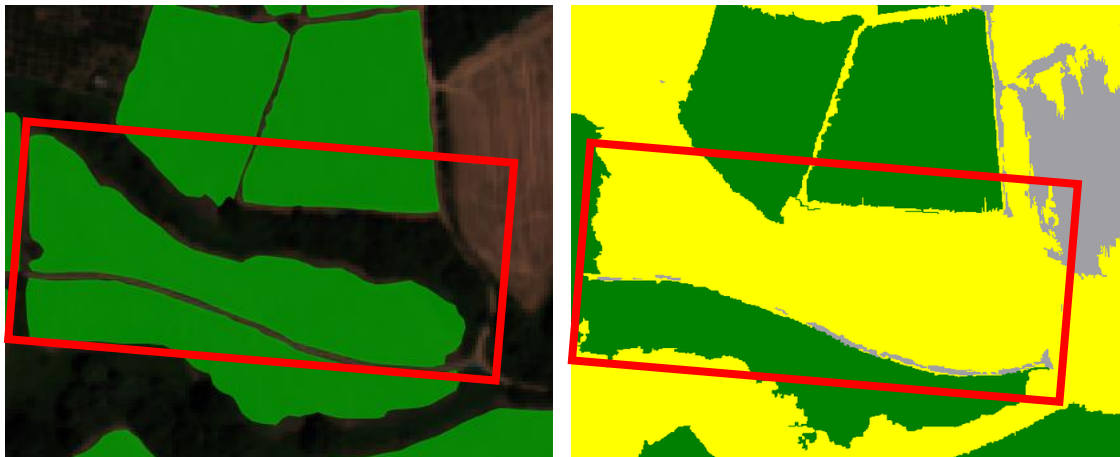
Σχήμα 5.6 – Περίπτωση λανθασμένης ταξινόμησης αντικειμένων που απεικονίζουν αμπέλια βλάστησης ως απλή βλάστηση ( error of omission ) στην εικόνα WV2 στην Νάουσα. Στο κόκκινο πλαίσιο επισημαίνεται η περιοχή λανθασμένης ταξινόμησης στην εικόνα ταξινόμησης και στην εικόνα δεδομένων ελέγχου.
