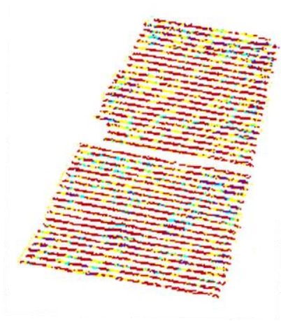
Σχήμα 5.12 – Περίπτωση λανθασμένα ταξινομημένων αντικειμένων (δεξιά) λόγω του προβλήματος καταγραφής του δέκτη, σε δύο αμπελοτεμάχια Cabernet Sauvignon στην WV2 εικόνα του Μεγαπλάτανου. Αριστερά παρουσιάζεται το αντίστοιχο τμήμα της συγχωνευμένης εικόνας σε φυσικό έγχρωμο σύνθετο.
