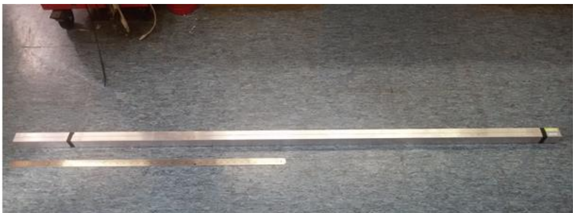
Σχήμα 3.13 : Ορθογωνικής Διατομής Ράβδοι Οροφής Διάστασης 40mm x 20mm x 2010mm.
