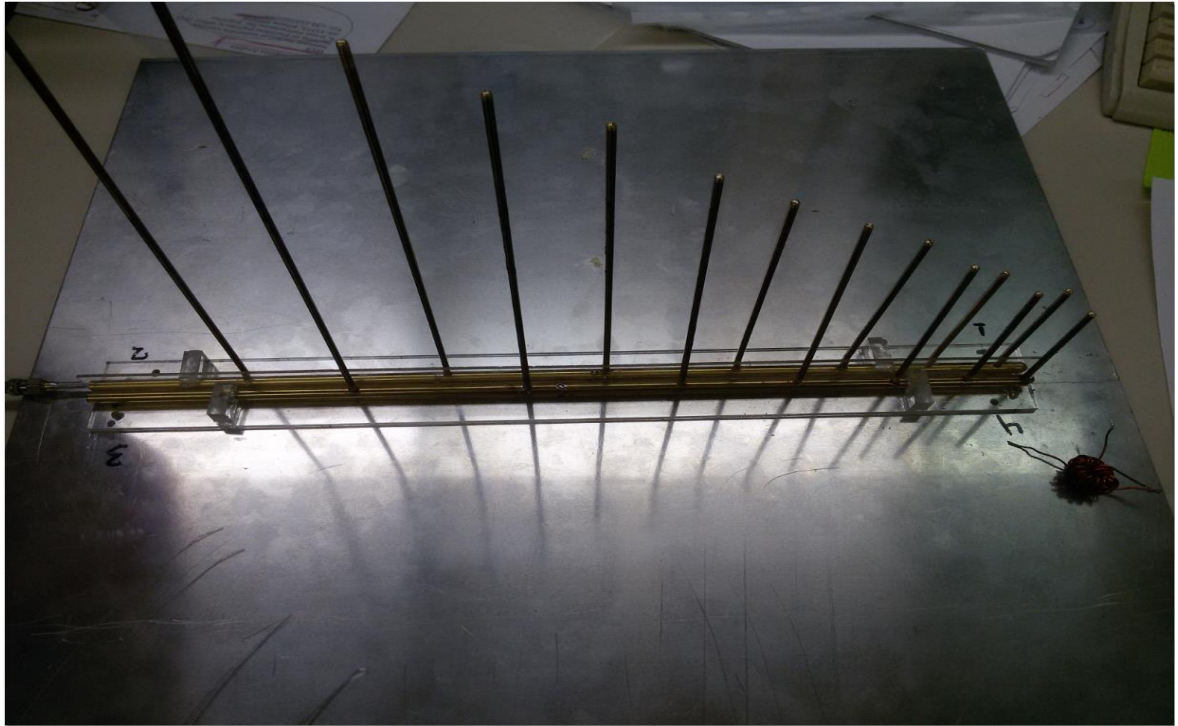
Σχήμα 2.13 : Πειραματικό Μοντέλο Απεικόνισης των 9 Μεγαλύτερων Στοιχείων της Ground Plane Mounted LPA, με \tau=0,9 και \alpha=30^\circ (E.Z. 300-800 MHz).
