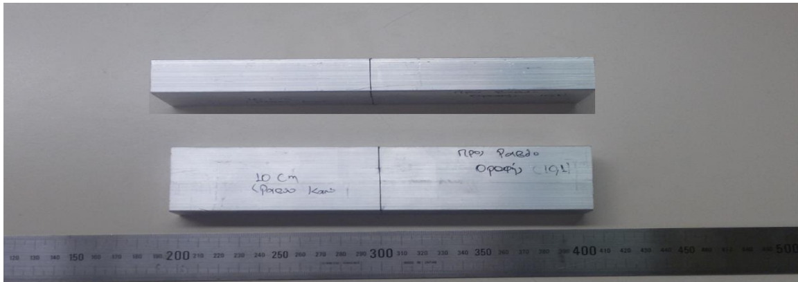
Σχήμα 3.16 : Ορθογωνικής Διατομής Ράβδοι Σύνδεσης Οροφής με Καπό Διάστασης 40mm x 20mm x 200mm.
