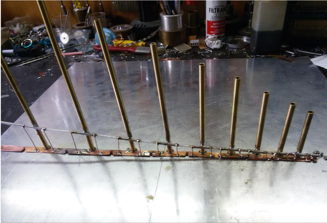
Σχήμα 2.6 : Πειραματικό Μοντέλο Απεικόνισης των 9 Μεγαλύτερων Στοιχείων της Shunt-Fed LPMA, με \tau=0,85 και \alpha=30^\circ (E.Z. 300-815,21 MHz).
