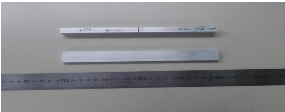
Σχήμα 3.17 : Ορθογωνικής Διατομής Ράβδοι Σύνδεσης Καπό με LPDA Διάστασης 20mm x 10mm x 200mm.
