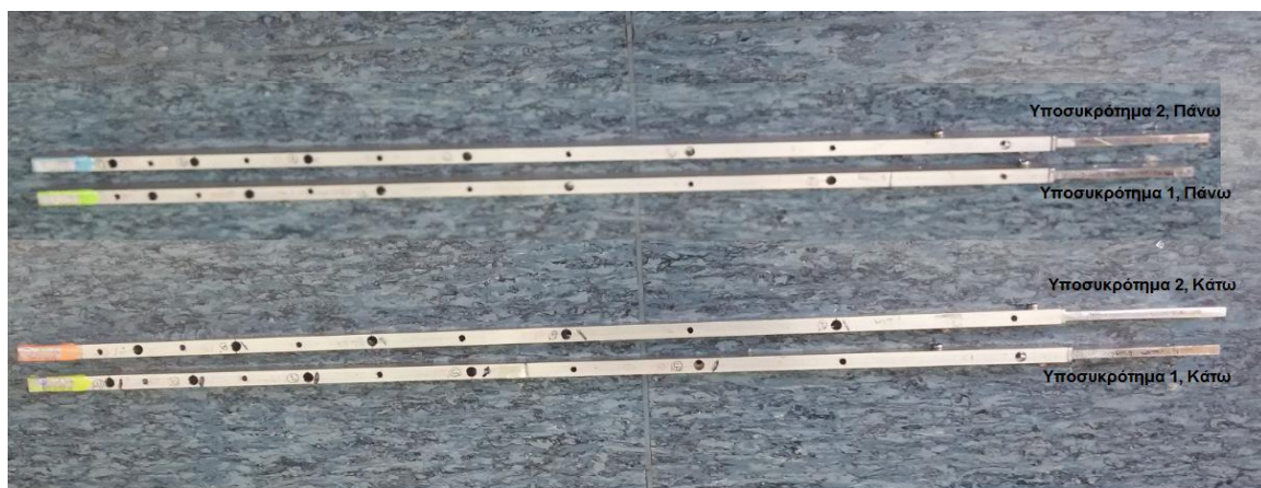
Σχήμα 3.24 : Οπές Τοποθέτησης Διπόλων LPDA.
