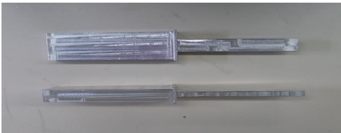
Σχήμα 3.20 : Προσαρμογέας Σύνδεσης Ράβδων Καπό με Οροφής.
