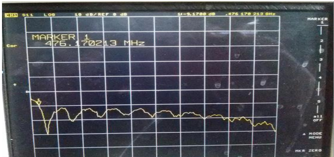
Σχήμα 2.17 : Μέτρηση της Πειραματικής Ground Plane Mounted LPA με Χρήση Τοροειδούς 4:1 Balun.
