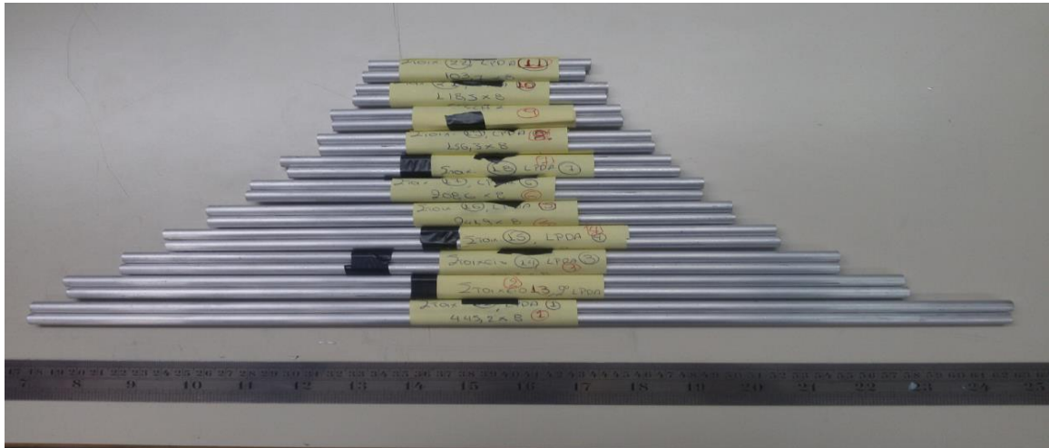
Σχήμα 3.19 : Κυλινδρικής Διατομής Ράβδοι Διπόλων της LPDA.
