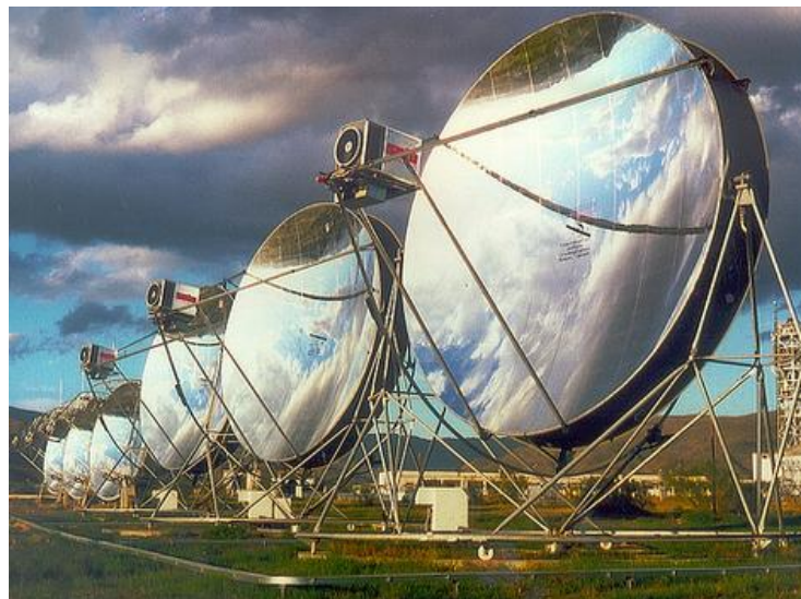
Σχήμα 1.12: Παραβολοειδείς συγκεντρωτές με μηχανές Stirling στο ερευνητικό κέντρο Plataforma Solar de Almeria [29] της Ισπανίας. Κάθε δίσκος παράγει 10kW ηλεκτρικής ισχύος [19]
