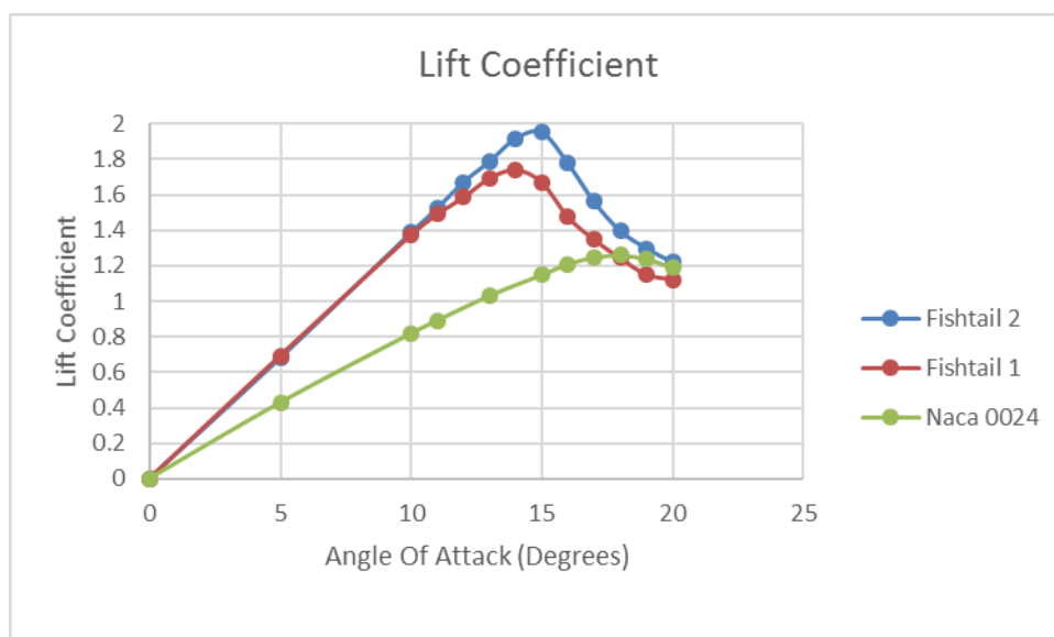
Σχήμα 3.35: Διάγραμμα συντελεστή άνωσης σε συνάρτηση με την γωνία προσβολής για τις τρεις υδροτομές.
