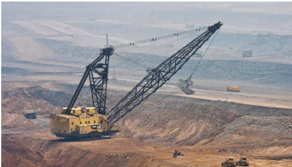
Εικόνα 2.3: Εκσκαφέας με συρόμενο κάδο
