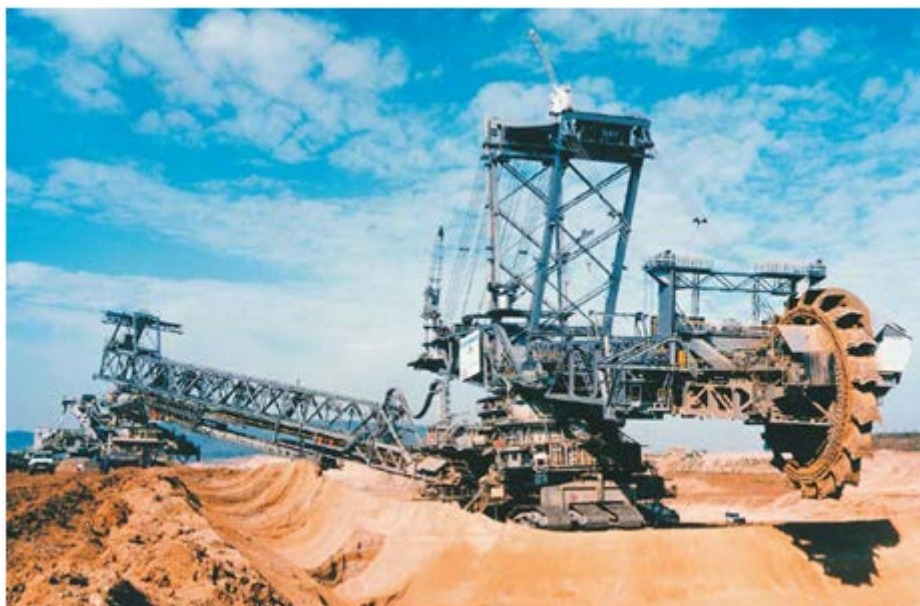
Εικόνα 1.1: Μέθοδος συνεχούς εξόρυξης με χρήση καδοφόρων εκσκαφών (Tenova, 2011)
