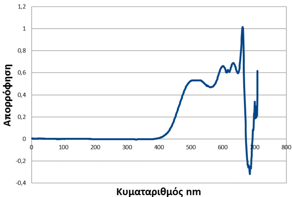
Διάγραμμα 8.4: Φάσμα UV-VIS για το Poly(9,9-di-n-dodecylfluorenyl-2,7-diyl) σε διάλυμα THF
