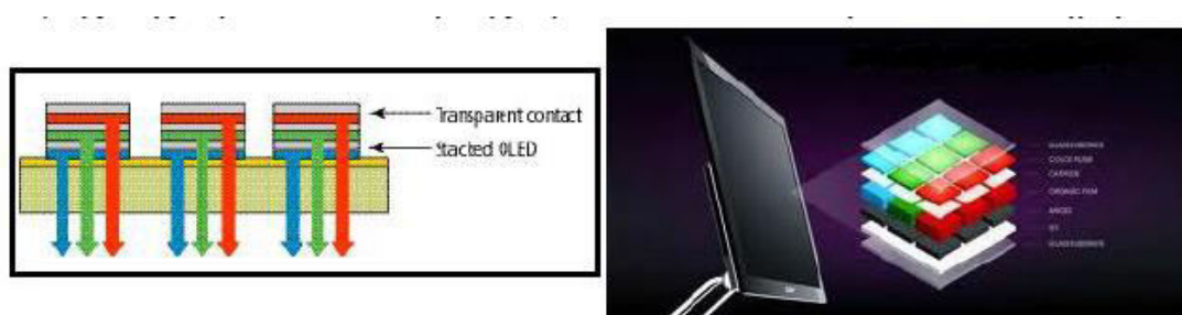
Εικόνα 3.22: Απεικόνιση δομής στρωματοποιημένης OLED(SOLED) (αριστερά) και τηλεόραση που βασίζεται στην τεχνολογία της SOLED (δεξιά)
