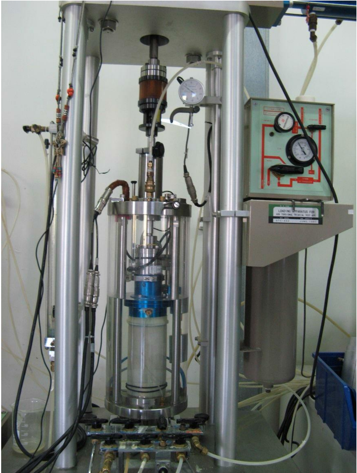
Σχήμα 4.3. Τριαξονική κυψέλη (διακρίνεται στο κέντρο της συσκευής). Δεξιά πάνω βρίσκεται το σύστημα τροφοδότησης για την επιβολή στρεπτικού φορτίου και από κάτω η δεξαμενή εκτόνωσης
