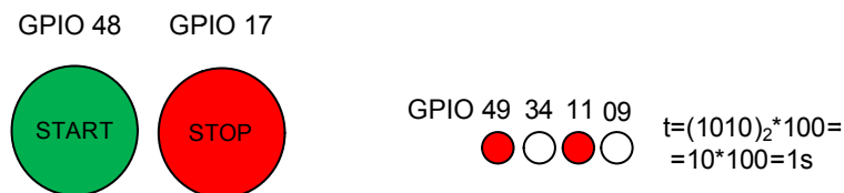
Σχήμα 4.11: Παρουσίαση στιγμιότυπου λειτουργίας του χρονομετρητή και αντιστοίχιση GPIO pins με τις λειτουργίες του.
