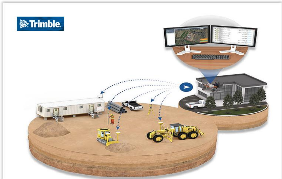
Εικ. 2.33: Πλήρης εποπτεία εργοταξίου με τη χρήση του διαδικτύου και των δορυφορικών συστημάτων
