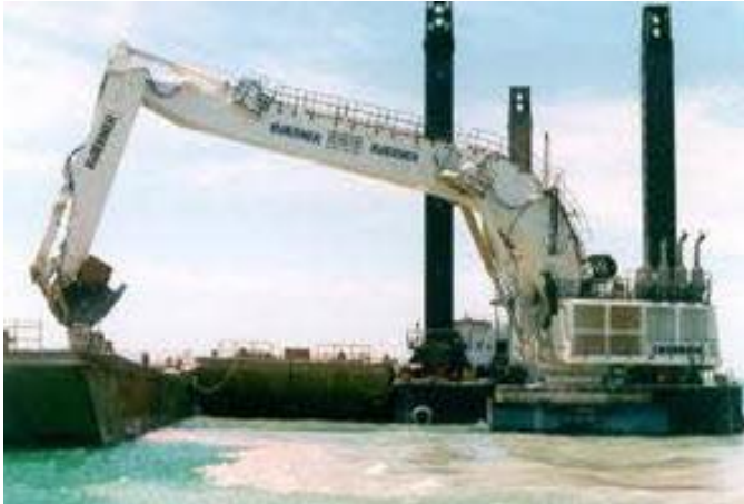
Εικ. 2.30: Πλωτός εκσκαφέας με εξοπλισμό Leica-Icon (Πηγή: http://www.leica-geosystems.us/en/Leica-iCON_97929.htm )
