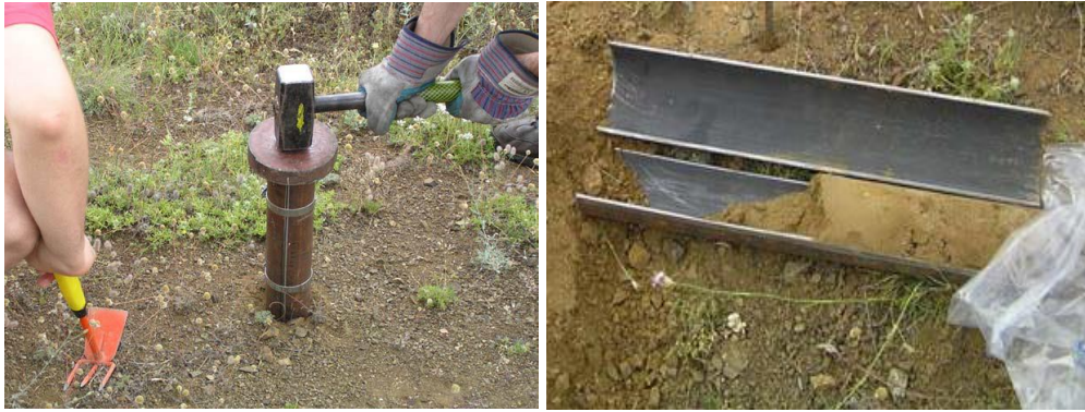
Σχήμα 2-6: Εισαγωγή του δειγματολήπτη στο χώμα (αριστερά) και ληφθέν δείγμα χώματος (δεξιά) (Πετροβίτσος, 2011).
