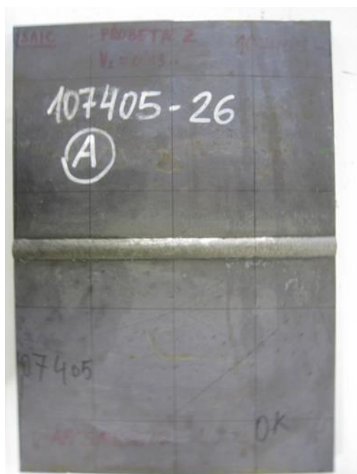
Εικόνα 4.9: Σημαδεμένη πλάκα έτοιμη προς κοπή και παραγωγή δοκιμίων.
