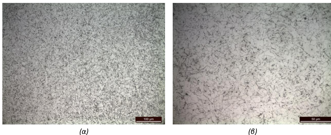
Εικόνα 5.5 : Μικρογραφία ζώνης τήξης συγκόλλησης FCAW χάλυβα AH36 (περιοχές 1 , 3 , 5).
