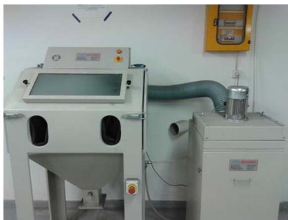
Εικόνα 4.10 : Μηχανή αμμοβολής στο μηχανουργείο του ENT.
