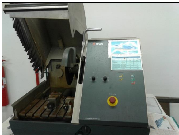
Εικόνα 4.3 : Δισκοτόμος μηχανουργείου ENT.
