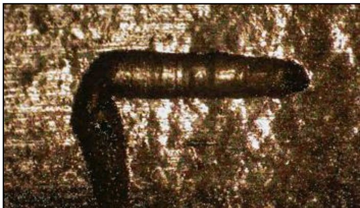
Εικόνα 1.3 : Γραμμική ένωση πόρων, γνωστή ως «worm tracks».
