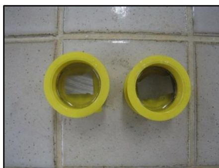
Εικόνα 4.2 : Δοκίμια εμβάπτισμένα σε εποξειδική ρητίνη.
