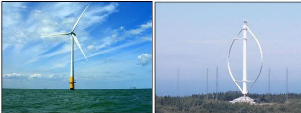
Σχήμα 2.1: Τύποι ανεμογεννητριών α) οριζοντίου άξονα [2.1], β) κατακόρυφου άξονα [2.2]
