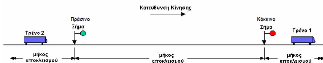
Σχήμα 4.26: Απλουστευμένο σχέδιο λειτουργίας τμήματος αποκλεισμού (Καλτσούνης, 2000)
