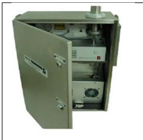
Εικόνα 4.1: Το όργανο μέτρησης GRIMM-Ambient Dust Monitor #365, που βρίσκεται τοποθετημένο στο κτήριο Φυσικής του ΕΜΠ.
