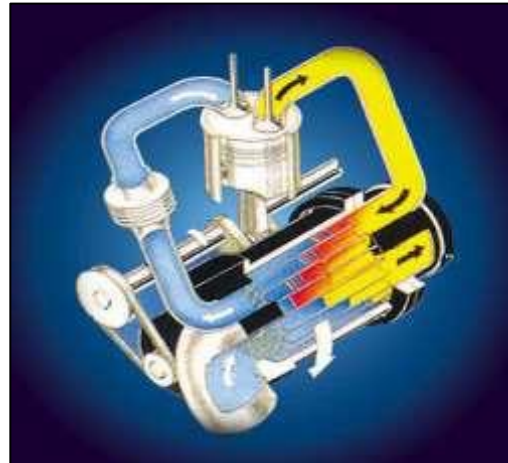
Σχήμα 1.5: Σύστημα υπερπλήρωσης με την μέθοδο Comprex
