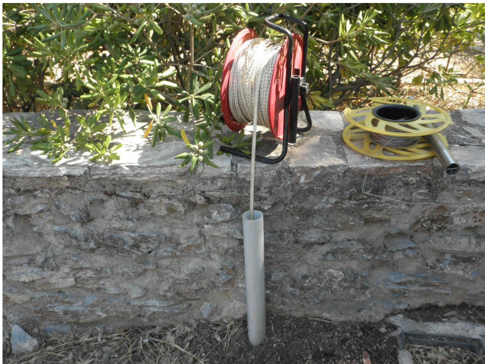
Εικόνα 6.2 Μέτρηση στάθμης με σταθμήμετρο σε γεώτρηση του Θορικού (Μάρτιος 2014)
