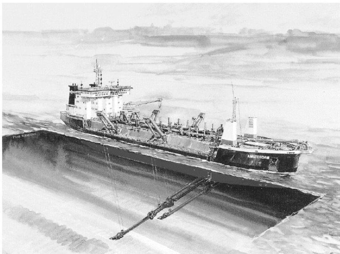
Εικόνα 6-22: Άποψη πραγματικής βυθοκόρου με συρόμενη αναρρόφηση. (Vlasblom, 2003)
