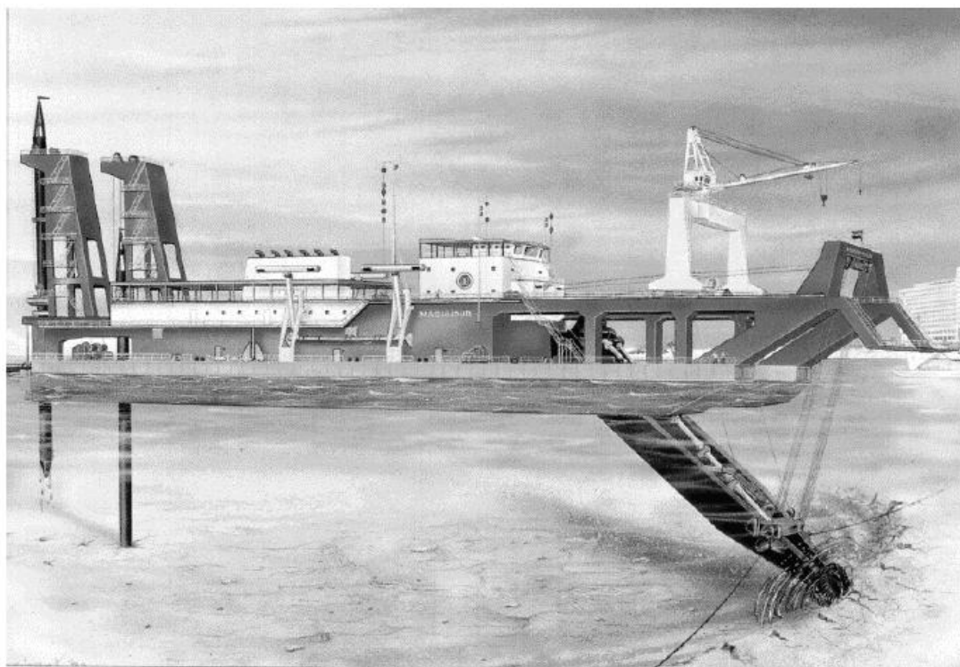
Εικόνα 6-17:Άποψη πραγματικής βυθοκόρου αναρρόφησης με κεφαλή κοπής. (Vlasblom, 2003)
