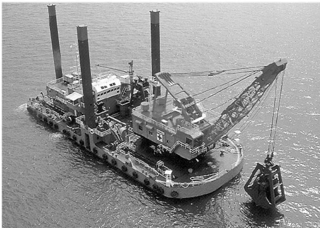
Εικόνα 6-2: Άποψη πραγματικής βυθοκόρου με αρπάγη. (Vlasblom, 2003)
