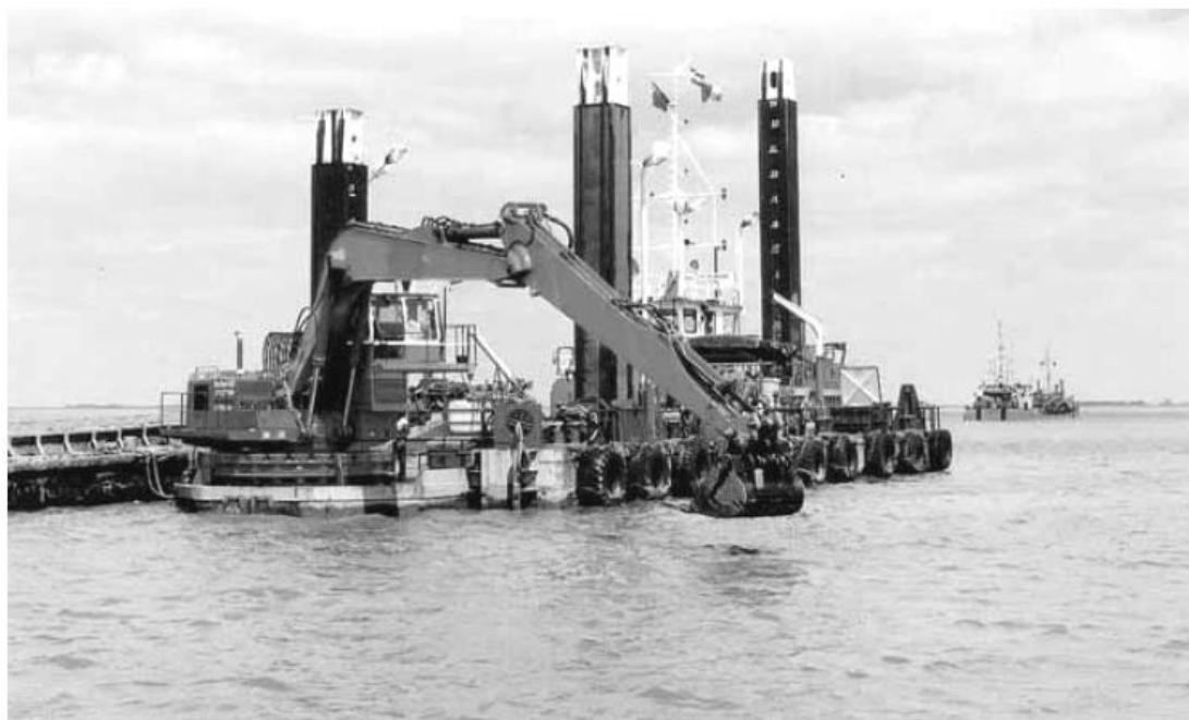
Εικόνα 6-10: Άποψη πραγματικής βυθοκόρου όπου διακρίνεται ο υδραυλικός βραχίονας. (Vlasblom, 2003)
