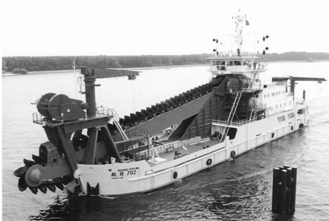
Εικόνα 6-6:Άποψη πραγματικής βυθοκόρου με βαγονέτο,όπου διακρίνεται η αλυσίδα των κάδων. (Vlasblom, 2003)
