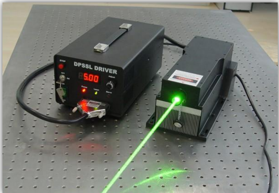
Εικόνα 3.20. Laser πράσινου φωτός στα 532nm (πηγή: διαδικτυακός ιστότοπος).
