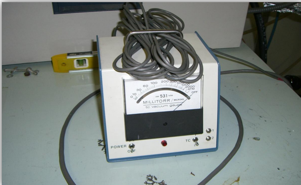
Εικόνα 3.17 Μετρητής κενού (πηγή: φωτογραφίες κατά τη διάρκεια του πειράματος στο Εθνικό Κέντρο Έρευνας Φυσικών Επιστημών «ΔΗΜΟΚΡΙΤΟΣ»).
