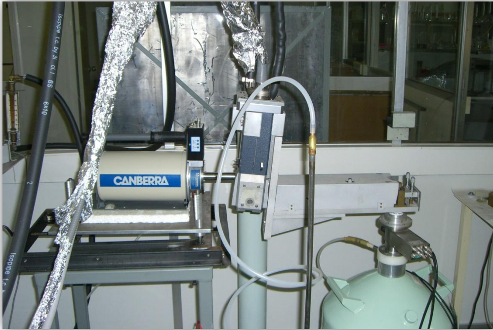
Εικόνα 3.3 Στην εικόνα φαίνεται η εργαστηριακή πηγή ακτίνων Χ (πηγή: φωτογραφίες κατά τη διάρκεια του πειράματος στο Εθνικό Κέντρο Έρευνας Φυσικών Επιστημών «ΔΗΜΟΚΡΙΤΟΣ»).
