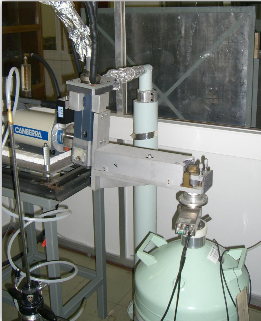
Εικόνα 3.5 Εργαστηριακή πηγή ακτίνων Χ (πηγή: φωτογραφίες κατά τη διάρκεια του πειράματος στο Εθνικό Κέντρο Έρευνας Φυσικών Επιστημών «ΔΗΜΟΚΡΙΤΟΣ»).
