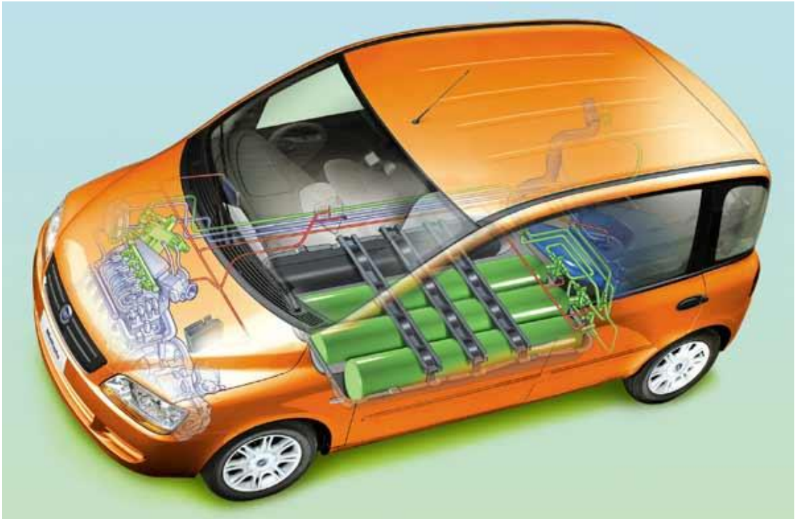
Εικόνα 14: Fiat Multipla Natural Power – Φιάλες μεθανίου
