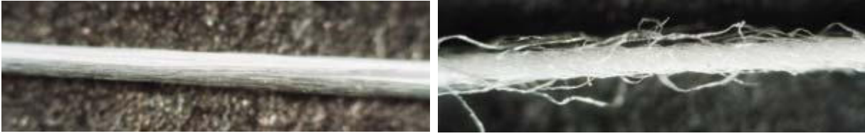
Σχήμα 1-3: Επίπεδο νήμα (δεξιά) και στριμμένο πολυινικό νήμα (αριστερά).
