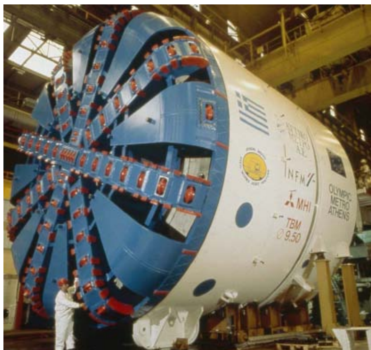
Εικόνα 1.3: Μηχάνημα ολομέτωπης κοπή(TBM). (Αττικό Μετρό, 2007)
