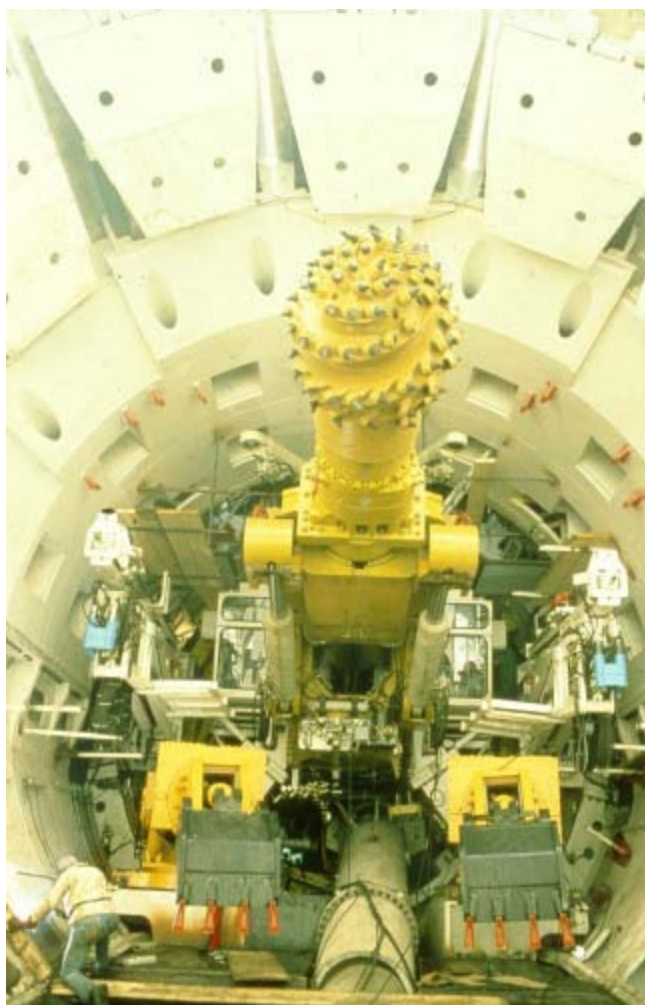
Εικόνα 1.4: Μηχάνημα σημειακής κοπής (Open Face Shield – OFS) (Αττικό Μετρό, 2007)
