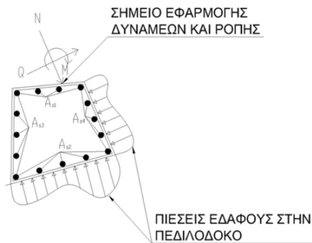
Σχήμα 11.3: Στατικό μοντέλο και αρίθμηση των οπλισμών. (Μελέτη Σήραγγας Διπλής Τροχίας, Αττικό Μετρό, 2007)
