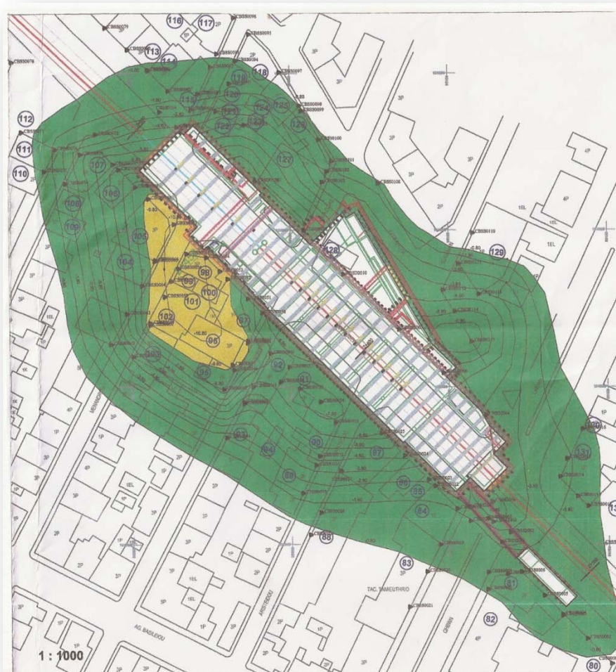
Σχήμα 10.1: Καθιζήσεις επιφάνειας στο σταθμό "Ανθούπολη" (ΑΤΤΙΚΟ ΜΕΤΡΟ Α.Ε.)
