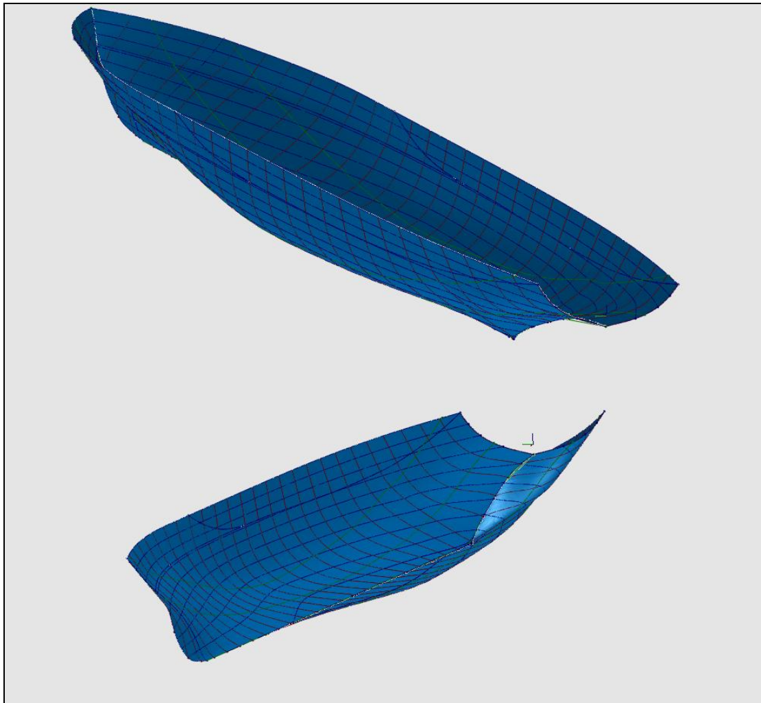
Σχήμα 5.2.19: Η μοντελοποιημένη γάστρα
