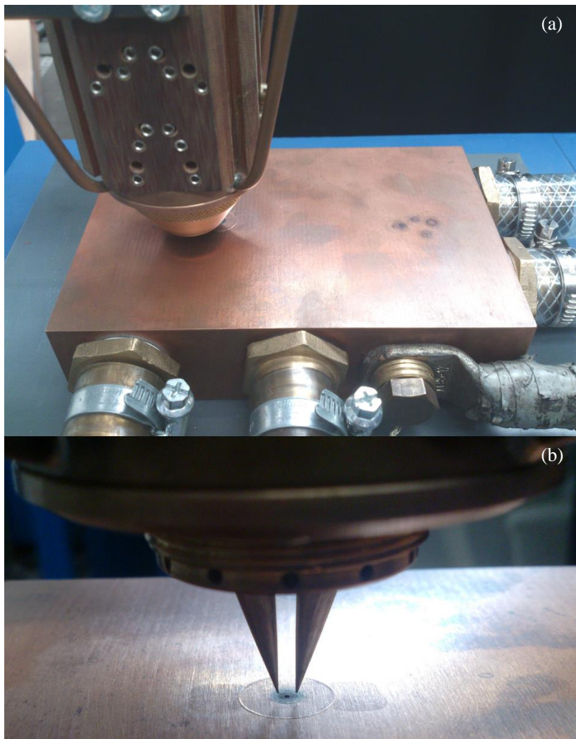
Figura 64 - Aparato de medição de pressão do arco. (a): Tocha duplo eletrodo posicionada sobre o aparato de medição. (b): Imagem mostrando a tocha sem o bocal de gás de proteção permitindo visualizar os eletrodos e o orifício de medição
