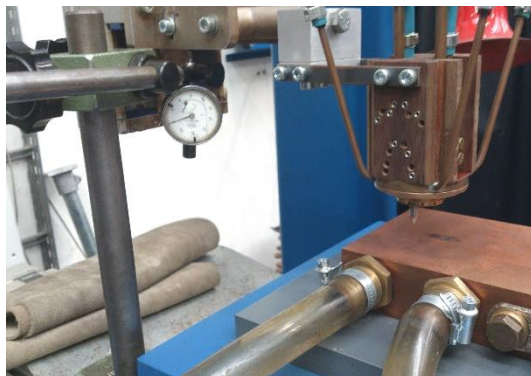
Figura 67 - Procedimento de aferição utilizando relógio comparador para verificar se os sistemas utilizados para movimentação estavam adequados
