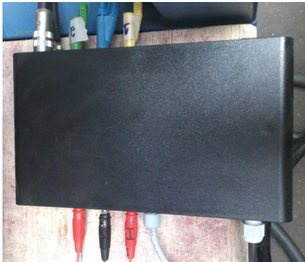
Figura 59 - Módulo eletrônico construído para isolar os sinais de tensão durante os pulsos de alta frequência da abertura do arco
