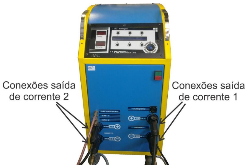
Figura 41 - Fonte de soldagem IMC Digiplus A7 em versão desenvolvida para o processo TIG duplo eletrodo em parceria com o LABSOLDA-UFSC
