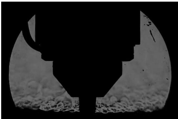
Figura 109 - Imagem do fluxo de gás na tocha TIG-DE obtida pela técnica Schlieren utilizando um anteparo na frente do arco. Gás utilizado: Argônio 20 l/min
