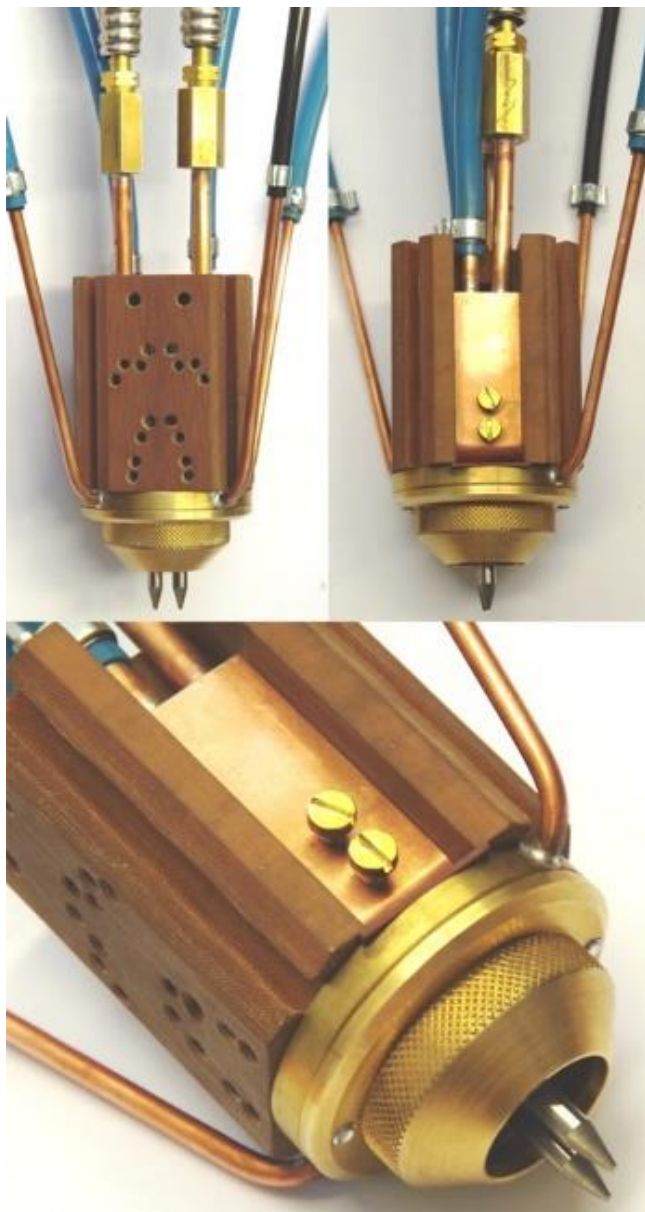
Figura 54 - Imagens da segunda versão de tocha TIG duplo eletrodo desenvolvida e fabricada em parceria entre o LABSOLDA-UFSC e o ISF-RWTH-Aachen
