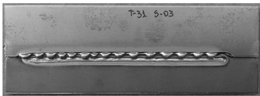
Figura 4 - Aspecto da formação de defeitos tipo humping em soldagem de chapas de aço carbono 3mm de espessura em junta sobreposta utilizando o processo TIG
