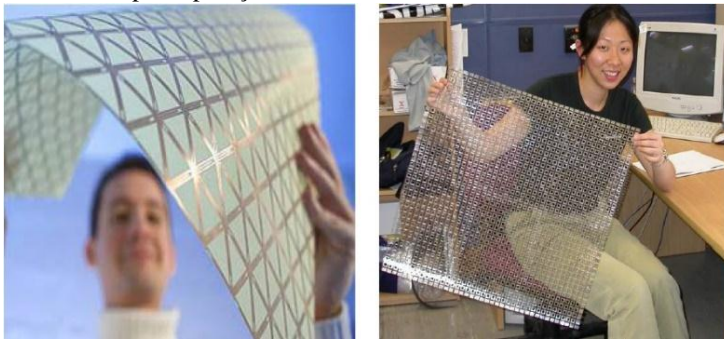
Figura 2.4. FSS para aplicações em WLANs.
