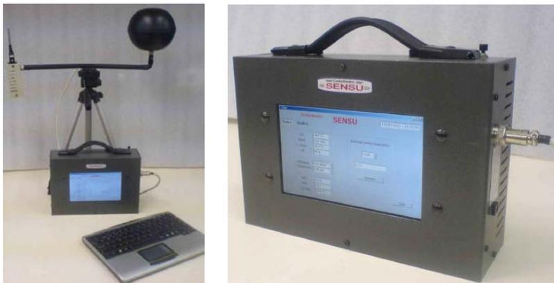
Assim, o confortímetro SENSU foi utilizado para medir todos os dados ambientais necessários nas avaliações de conforto térmico: temperatura do ar, velocidade do ar, umidade relativa e temperatura de globo. A temperatura e a velocidade do ar medidas pelo confortímetro foram feitas a partir de um sensor que funciona por meio da diferença de
