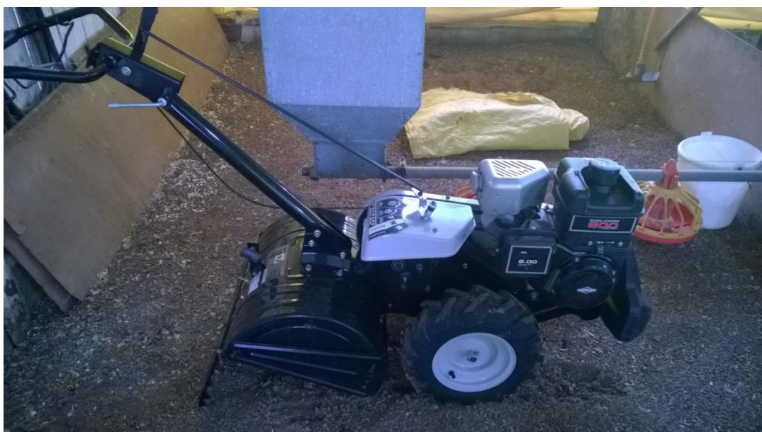
Figura 3. Motocultivador “batedor de cama”.
