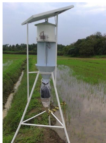
Figura 16. Armadilha Sonne com o aparato contendo a massa fúngica. Fonte: Débora Dal Zotto, 2015.
