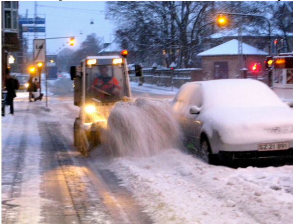
Figura 15: Remoção da neve na ciclovia antes da via, Copenhague.
