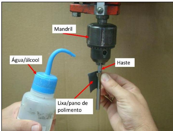
Figura 9: Foto do processo de lixamento/polimento das hastes de ferro fundido cinzento.
