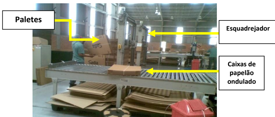
Figura 24 – Saída da Impressora, onde se encontram a unidade de paletização chamada esquadrejador.
