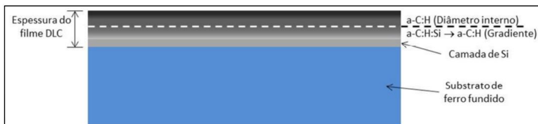
Figura 7 - Representação esquemática do filme de DLC aplicado em cilindros de ferro fundido.
